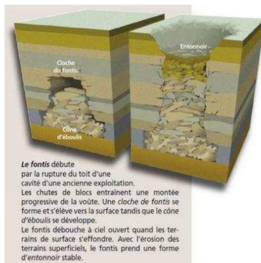
**Le fontis débute** par la rupture du toit d'une cavité d'une ancienne exploitation. Les chutes de blocs entraînent une montée progressive de la voûte. Une cloche de fontis se forme et s'élève vers la surface tandis que le cône d'éboulis se développe. Le fontis débouche à ciel ouvert quand les terrains de surface s'effondrent. Avec l'érosion des terrains superficiels, le fontis prend une forme d'entonnoir stable.
